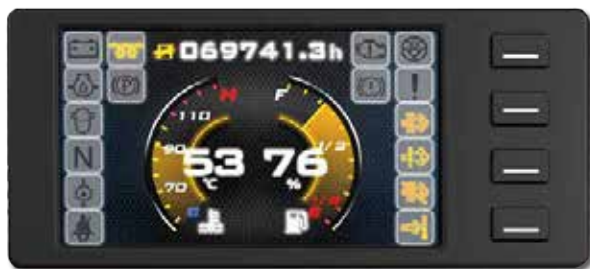
Quadro comandi interattivo: display a colori con 4 pulsanti interattivi e funzione di comunicazione can-bus.
